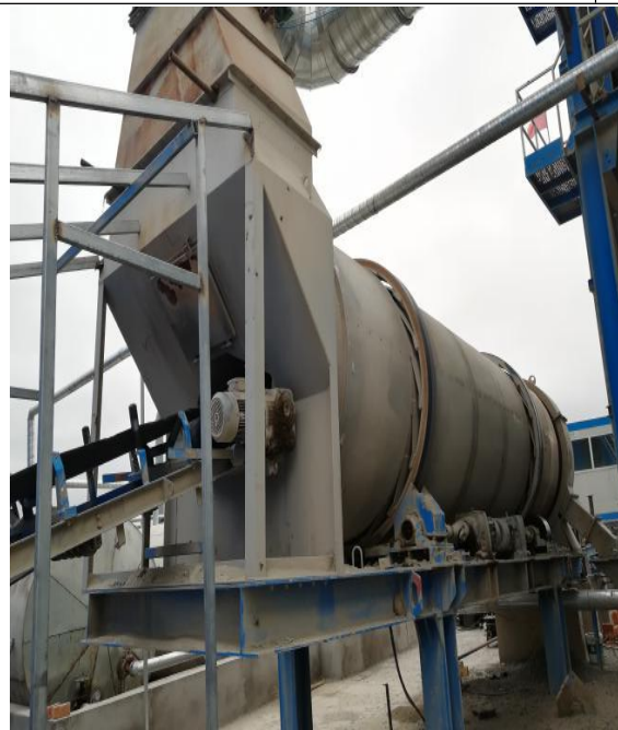
烘干筒 布袋除尘器, 15m 高的排气筒
