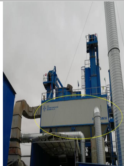
烘干筒 布袋除尘器, 15m 高的排气筒
